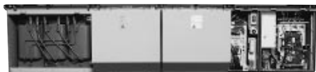
図2 150 kVAシリーズIGBT SIV装置 150 kVA以下のSIVは、この外形で標準化している。 150 kVA series IGBT SIV
