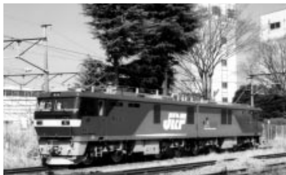
図1. EH500形式 交直流電気機関車 DC及びAC電化区間をスルーした運転が可能であり、目的地への大幅な到達時間短縮を達成した。 Type EH500 AC/DC dual-voltage locomotive
