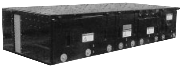
図4. 海外向け一体型主変換装置 IGBT素子を使用したインバータ部をはじめ,周辺機器である断流器,フィルタリアクトルを一括収納し,かつ,箱高さを500mmに抑えた低床タイプである。
