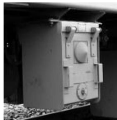
図2. 車上ビーコン 車両側に搭載される無線装置で、車両床下から地上ビーコンと交信する。
