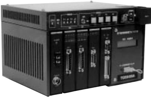
図6 . 電子踏切制御装置(リレーI/F型) 汎用シーケンサを応用した小型・軽量の制御装置で、サイズは280 mm(幅)×180 mm(高さ)×220 mm(奥行き)、質量は約6 kgである。
