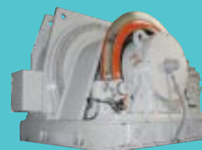
図5 1,000m/min級巻上機 小型・軽量化設計を実施した、永久磁石型同期電動機を採用しました。
