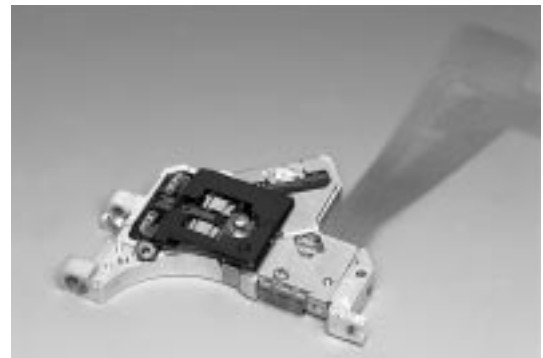
図9 .2波長レーザーを用いたピックアップ 厚み7.3 mmで,ハーフインチ厚の光ディスク装置が実現できる。 Newly developed 7.3 mm height optical pickup
