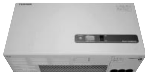
図1 4 kW住宅用太陽光発電PCS 個人住宅内に設置するPCSで、トランスレス方式である。 4 kW photovoltaic PCS for residential use
