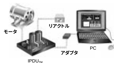
図8. IPDU TM 開発システム IPDU TM の開発システムが、PCからアダプタを介して簡単に接続できる環境になっている。
