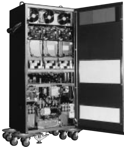
図5・大容量インバータ盤 EMC対策を盛り込んだコンバータ:3並列、インバータ:4並列構成の大容量変換装置を商品化した。 Large-capacity inverter panel
