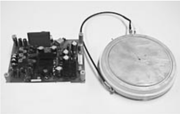
図5．IEGTとゲートドライバ ゲートドライブ基板は非常に小さい。 IEGT and gate driver
