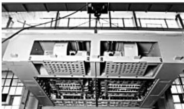
図4 . IEGTパワーユニット IEGTを使用した2レベル方式コンバータ及びインバータユニットを搭載した新幹線駆動用電力変換装置を示す。
