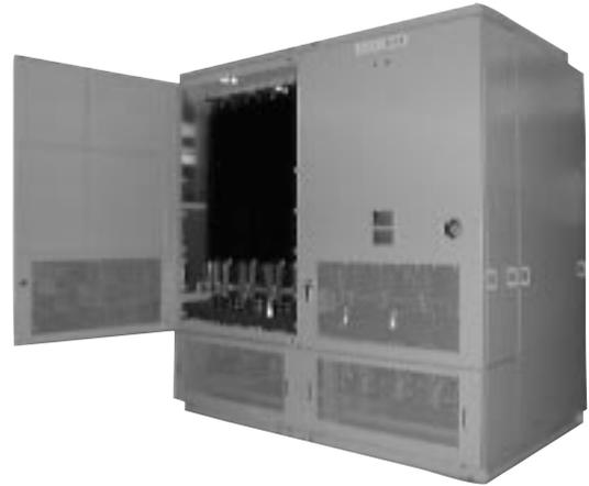
図9．ヒートパイプ冷却方式整流器 冷媒として環境に優しい水を使用し、また、従来製品と同等の据付け面積で、リプレースを容易にしている。
