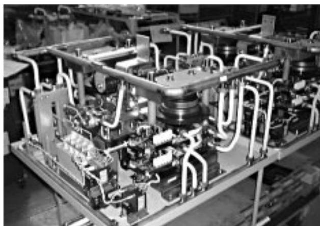
図5．2直列 2並列 IEGT モジュール この試作モジュールにより、IEGT の直並列接続技術を検証した。
