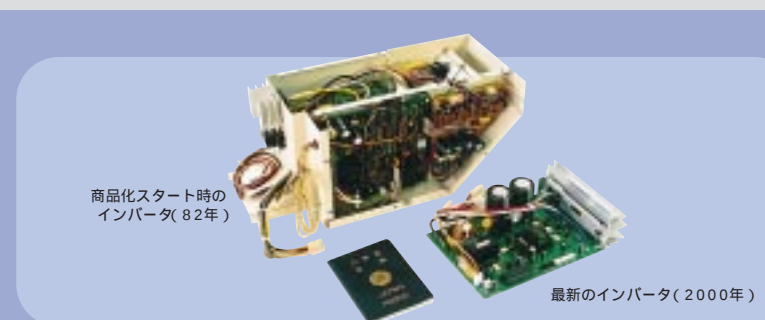
図3 インバータの比較 商品化スタート時に比べ、高効率化、コンパクト化、低価格化など大幅に進化し、特に容積は1/8になりました。
