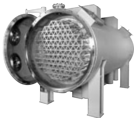
図3．オゾン発生器 発生機内に多くの円筒形電極が取り付けられており、本数により最大発生量が決定する。 Ozone generator (open)
