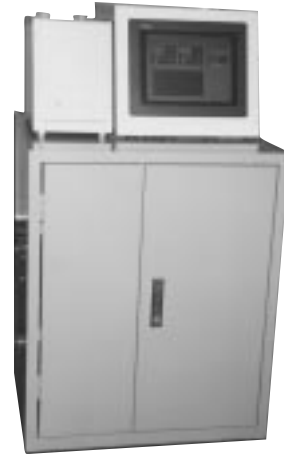
図5 . 有害物質監視支援装置 試作機 自動洗浄 , 自動校正機能を備え , 連続測定ができる。
