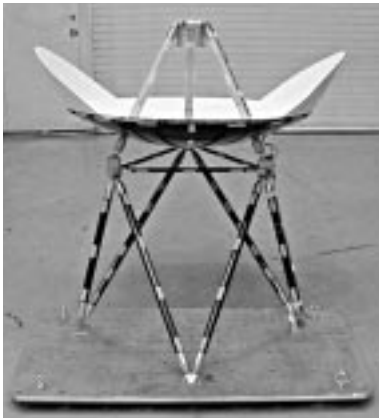
図4 . HACアンテナ( 1m ) 反射鏡の左右にあるのが大型アンテナとの干渉を回避するための遮蔽板である。 HAC antenna
