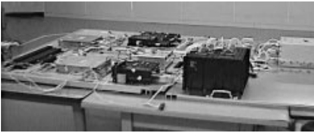
図3 . HACサブシステム( アンテナを除く )の外観 アンテナを除く HAC機器の全体を示す。右端がセシウム原子時計。 HAC subsystem (excluding HAC antenna)
