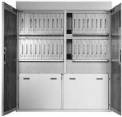
図3 . 固体化ASR送信機 32台のパワーアンプモジュール出力を合成し、30 kW以上の送信出力を得る。
