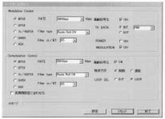
図4 . パラメータ設定画面 モデムの変復調方式パラメータの設定を行う。
