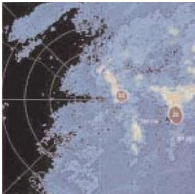
図9 . ダウンバースト検出画像 赤色の楕円によりダウンバーストの発生位置が示される。
