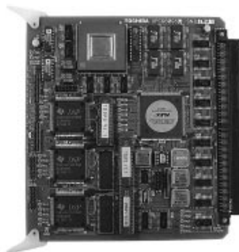
図4. 高速10.5 kbpsチャネル変復調処理ユニット DSPのソフトウェアを変えることにより,衛星回線のチャネル種別(P/R/T/C)を変えることができる。 High-speed 10.5 kbps channel modem processing unit
