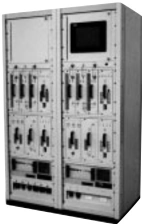
図5. SSRモードS装置 送信機、受信機、信号処理器及びトランザクション制御器が収容される。 SSR Mode S equipment
