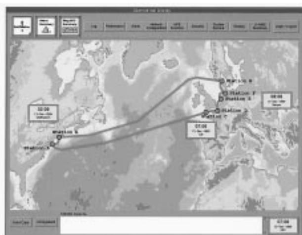
図6 . NMEのネットワーク画面(ノーアラーム状態) NMEが監視しているネットワークの、どの局舎、どの区間でアラームが発生しているかがひと目でわかる。この画面から特定のNPE、もしくは特定局舎のアラーム情報を一覧で見ることができる。
