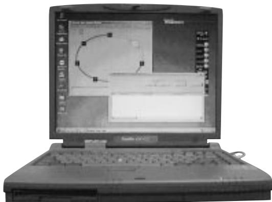
図2. CPT 局舎内の特定のNPEと接続して、NPE設置時の初期設定や保守に使用される。
