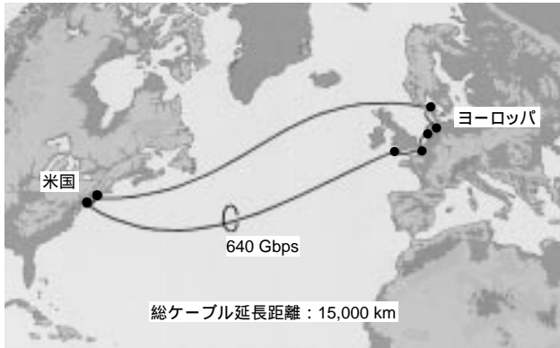
図5 . TAT 14ケーブルネットワーク TAT 14ケーブルネットワークシステムは、大西洋を横断し、6か国を結ぶ光リングシステムである。 TAT - 14 cable network
