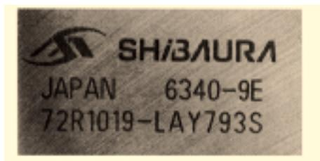
図8. CSPへのマーキング例 シリコン表面だけを加工しているため、内部回路にダメージを与えずにマーキングできる。
