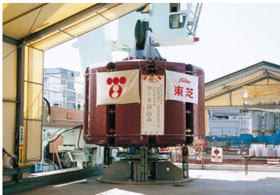
同期調相機回転子 Rotor of synchronous condenser
