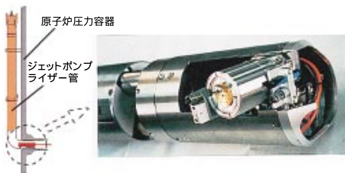
レーザ脱鋭敏化処理装置 Laser desensitization treatment device
