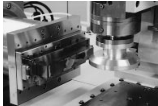
図5. 金型の加工 精密加工装置を用いて、自由曲面をダイヤモンド工具で切削加工した。 Precision machining of cavity surface of mold
