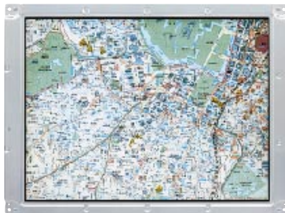
図1. 対角52.8 cm( 20.8型 )192 ppi TFT-LCD 低抵抗配線材料の開発、画面4分割パラレルデータ伝送方式により、大画面かつ超高精細なLCDを実現できた。
