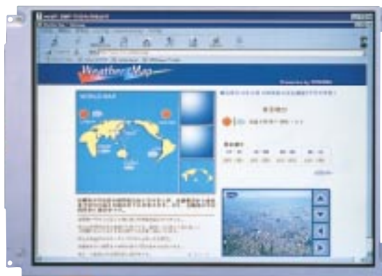
図1 10.4型XGA p-Si TFT-LCD(LTM10C306L) B5サイズノートPCに搭載可能な、10.4型XGA p-Siモジュールを開発した。 10.4-inch diagonal, p-Si TFT-LCD
