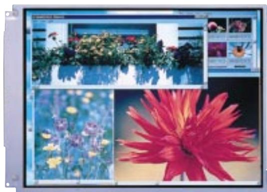
図7 10.4型XGA TFT-LCDの表示画像 p-Si駆動回路をガラス上に作り込むことで、10.4型で78万画素のXGA表示を実現し、123ppiの高精細表示を可能としている。
