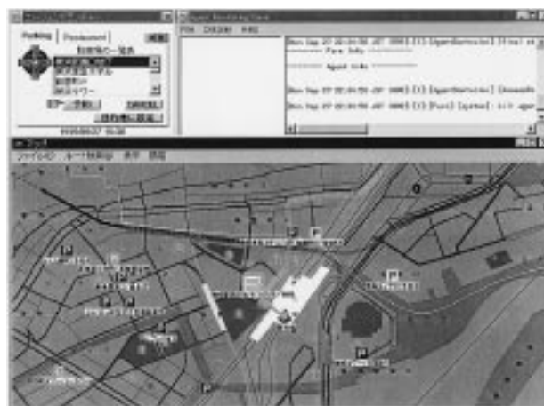
図4 . InfoMirror TM による駐車場情報表示 InfoMirror TM を用いることで、リアルタイムな満空情報の提供を実現している。 Example of parking lot information presentation using InfoMirror TM
