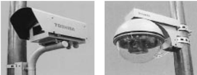
(a)揺れ防止カメラ(TC5700)を照明ポールに設置した例 (b)揺れ防止カメラ(TC5100)を照明ポールに設置した例
