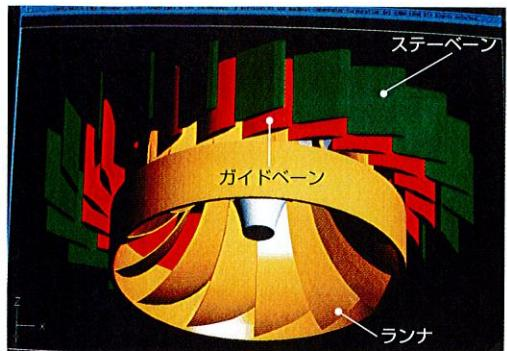
図 8. 水車改修範囲 ランナは更新し、ステーベーン、ガイドベーンは改造して性能向上を図った。
