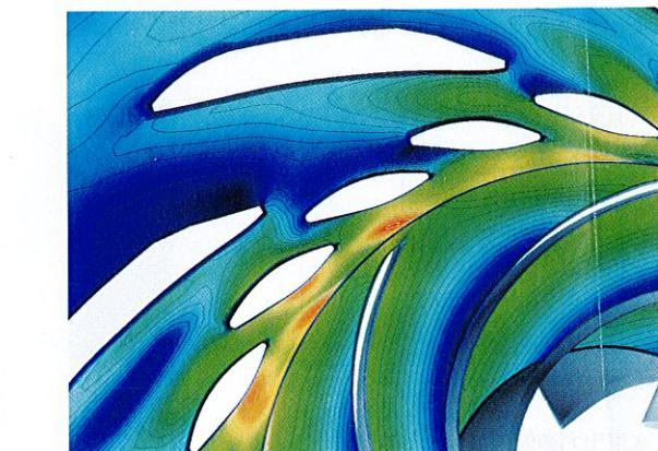
図4. 非定常流れ解析結果 ポンプ運転におけるランナと静止部翼の干渉のようすを示す。
