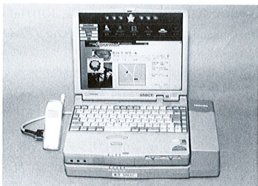
図5. AWL端末の試作機 19GHz帯を用いて、当社技術展に出展されたものである。ノートパソコンに無線部を追加した構成である。 Trial manufactured AWL terminal
