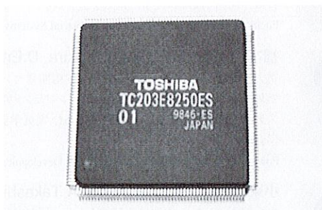
図5. 言語プロセッサ IEC言語を高速処理するカスタムLSIを示す。
