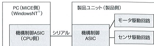
図5. MICEのシステム構成 CPU側機構制御ASICをPCに搭載し、PCから直接製品ユニットの機構を制御する。
