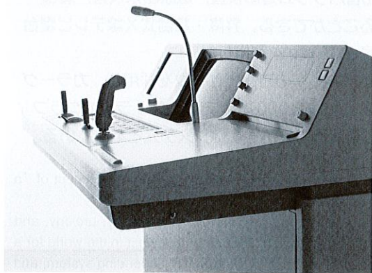
図2. 遠隔操作卓 パネルコンピュータとX線テレビモニタなどを内蔵したデスクタイプの操作卓である。 Remote control console
