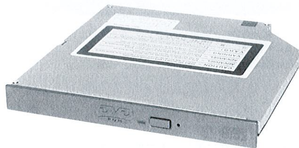
図 1. 4 倍速 DVD-ROM SD-C2202 幅 128 mm, 厚さ 12.7 mm, 奥行き 126.1 mm のノート PC 用 DVD-ROM である。
