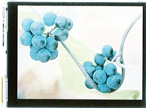
図6. 202ppi 4インチ poly-Si TFT-LCDの外観 信号入力部はパネル左辺1か所だけに配置されるシンプルな構造をもつ。 Appearance of 202-ppi, 4-inch diagonal, poly-Si TFT-LCD
