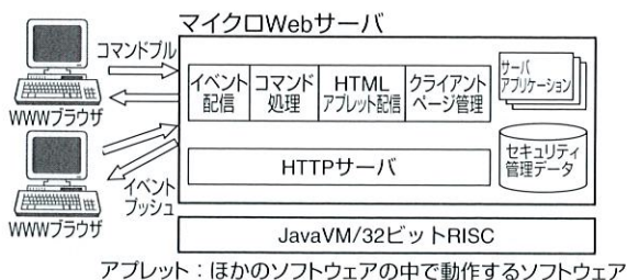
図11. \mu サーバのソフトウェア構成 HTTPサーバ機構の上に、各種機能をプラグイン可能なJavaクラスとして実装している。
