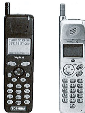
図6. cdmaOne 方式携帯電話 左は米国向け CDM-3000、右は国内向け CD-10 T。アナログ/デジタル両モードに対応するデュアルモード機である。
