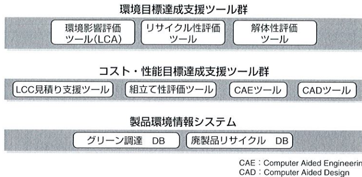
図4. ECP設計支援システムの構成 省エネルギー、省資源で、有害物質を使用せず、かつリサイクルを考慮した製品開発のための設計支援ツール群の構成を示した。Support system for designing environmentally conscious products (ECPs)
