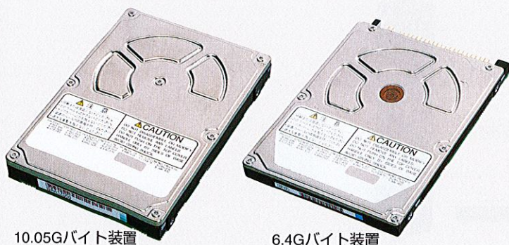
2.5インチ型磁気ディスク装置 10.05Gバイトシリーズ 10.05 Gbyte series 2.5-inch hard disk drive
