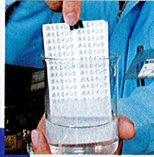
印刷画像の溶剤による消去 Decoloration of printer image by solvent
