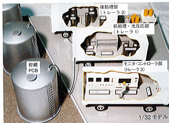
移動型PCB処理装置のイメージ(処理量200l/日) Image of movable process units for PCB detoxification
