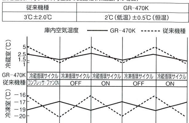
図10. 庫内の温度変動　2°C (低温) ± 0.5°C (恒温) を実現した。
