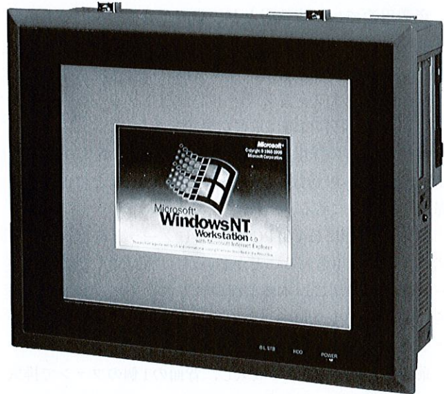
図7. FP3100 盤面への取付けができ、冷却ファンレス、薄型コンパクトを特長とした組込み型の産業用パネルコンピュータである。
