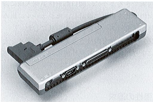
図 5. I/O アダプタ ケーブルを収納した携帯時の I/O アダプタの外観で、コンパクトで携帯性に優れている。
