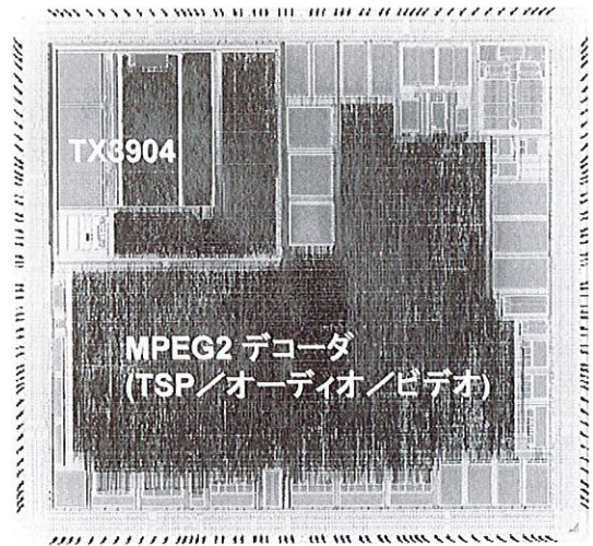
図 2. TC81220F のチップ TSP (トランスポートプロセッサ), TX3904 RISC コア, MPEG2 デコーダが1チップに集積されている。 Chip micrograph of TC81220F
