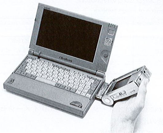
図5. PCカード部を使ってのPCとの接続 カード部分を開いて、PCのカードスロットに簡単挿入でき、画像転送も高速である。 Connection to PC using PC card slot
